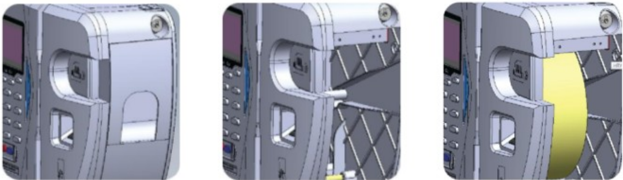
Figura 1: Instalação da bobina
